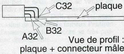
Pour les doués du fer à souder, il est possible de souder un faisceau de fils directement sur un connecteur mâle. Prévoir de la gaine thermo pour l'isolation électrique.
